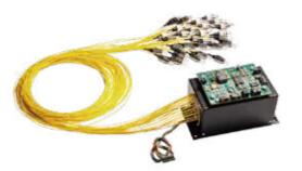
OSX-100は、信頼性が高くカスタマイズ可能なベンチトップ型の光スイッチで、研究用途から生産工場用途まで幅広くご利用いただけます。シングルモードまたはマルチモード で利用でき、チャネル数は 1x2 から 1x400までの幅広いラインアップを揃えています。
