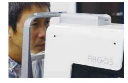
ARGOS®は、波長走査型OCT光源を使用した光学式眼内寸法測定装置で、白内障手術の時に、眼内レンズ選定のために必要となる眼球パラメータの測定を従来技術より も高精度、高速で行うことを実現した眼科向け医療機器です。また、波長走査型OCTとしては初めて、測定時に、角膜から網膜までの全眼部について2次元OCT画像を表示 することを可能にしました。さらに、従来、測定の難しかった重度の白内障で混濁した眼においても、測定の成功率を格段に向上させています。
