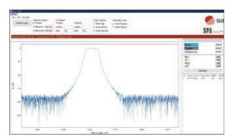
SPA-110は、santec波長可変レーザ(TSLシリーズ)の便利なアドオンモジュールであり、TSLと組み合わせたシステムは、OFDR(Optical Frequency domain Reflectometry) 技術により、光デバイスの後方反射、および、透過特性を空間領域で分析できます。このシステムは5µmの高サンプリング分解ののため、フォトニック集積回路(PIC)、および、シリコンフォトニクス(SiPh)デバイス内の構造を簡単に識別できます。
