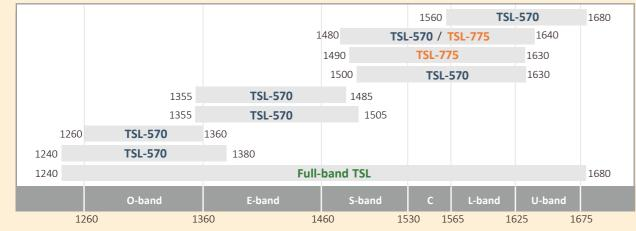
TSL-775は、第7世代となる高性能・高速波長可変レーザです。レーザ共振器および制御回路を完全に新設計することで、従来比2倍の高速スキャンが可能となり、 かつ狭スペクトル線幅と低ノイズ化を実現しました。本製品は最大160nmの広帯域波長可変が可能で、測定のスループット、精度を向上させることができます。これによ り評価現場、R&D、基礎研究など様々なアプリケーションで理想的なツールとなっております。また、光学系の振動対策、制御系のノイズ低減により外部共振器型波長可 変光源の特長である非常に高いQ値特性を活かした狭スペクトル線幅と、高周波数安定度の両立を実現したことにより、シリコンフォトニクス等、非常に高い周波数精度 を求められる最先端の研究分野でもご利用いただけます。
