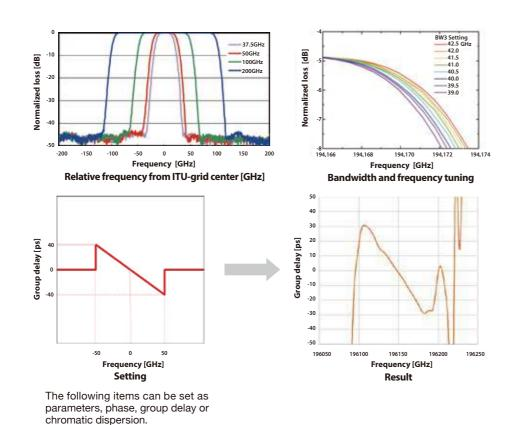
WSS-2000 は任意の光スペクトルをプログラム生成可能な LCOS ベースの光フィルタです。santec 独自の LCOS 技術により 柔軟性に富んだ帯域可変、減衰制御、 スイッチング動作を実現。さらに位相コントロール機能にも対応しております。WSS-2000 は次世代光ネットワークの評価及び検証に適しており、高速信号用の 光イコライザ、DWDM (光波長多重通信) や OFDM (直交周波数分割多重方式) チャネル選択フィルタ、WSS エミュレータとして、各種測定にご利用いただけます。
