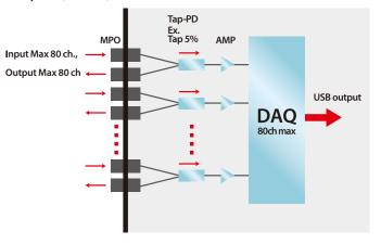
MPA-100 はピグテイル型フォトディテクタ・アレイのラック・マウント型製品です。MPO・MTP 多芯コネクタより入力される複数の光パワー信号をモニタします。 波長 850 nm 帯を検出するシリコンタイプと波長 1260 ~ 1610 nm 帯を検出する InGaAs タイプの光検出器よりお選び頂けます。光電流は内蔵する 16 ビットのマルチ 信号 DAQ インターフェースを介して、USB 端子より電圧出力されます。
