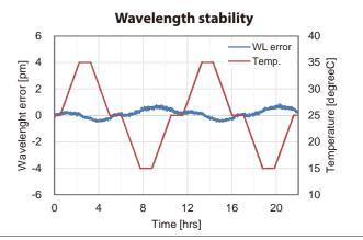
TSL-570は、高速スキャンと高い安定性の両方を備えた波長可変レーザーです。新しい光共振器設計により最大200nm/sの掃引速度制御とサブピコメートルの分解能と 精度を備えています。 さらに、新しい密閉型レーザーキャビティによりモードホップフリーで、すべての波長で安定した出力を提供します。また、使いやすいタッチパネル ディスプレイと、リモートコントロール用のイーサネット、GPIB、USBインターフェースを備えており、操作性も向上しています。ゆえに、光通信用光学部品の特性評価、フォ トニック集積回路や量子フォトニクス等の研究開発など様々なアプリケーションで理想的なツールとなっております。
